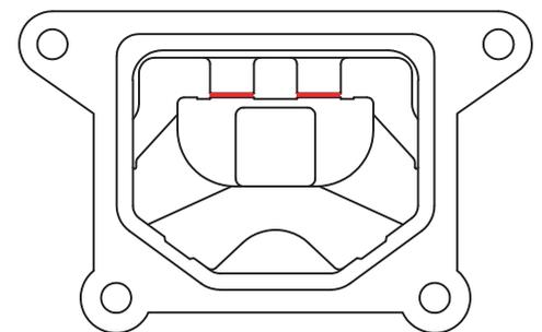
Para entender o funcionamento deste coxim no veículo, observar a figura, cada componente e sua respectiva fixação. A parte de alumínio do Coxim 3026 não pode estar aderida em sua parte superior (posição A), assim o Coxim não irá ter a deflexão (deformação) desejada na montagem com o motor.
