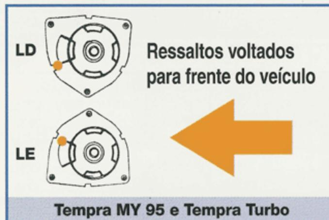
**NOTA 1:** O coxim superior do amortecedor dos veículos Tempra, deve estar posicionado corretamente sobre a mola helicoidal observando-se o seu sentido de montagem em relação à carroceria, conforme mostra a figura, pois, os mesmos são específicos para o lado direito e esquerdo.
